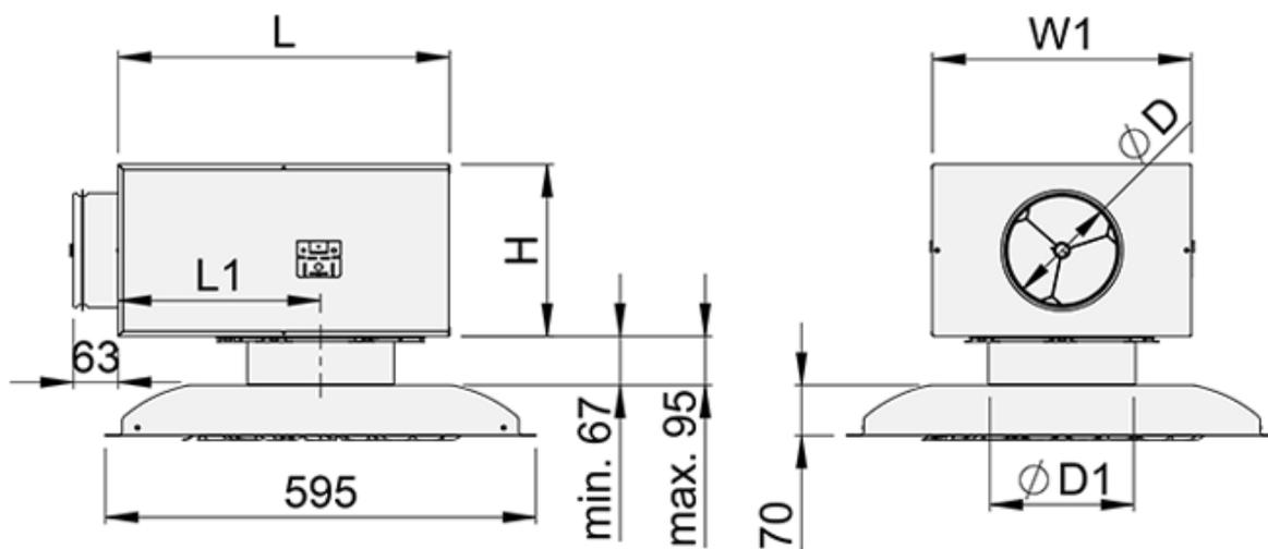
*Fig. 5. Dimensions du Halton Jaz JMC avec plénum Halton Pop PDI, manchette de raccordement placée à l'extérieur*
