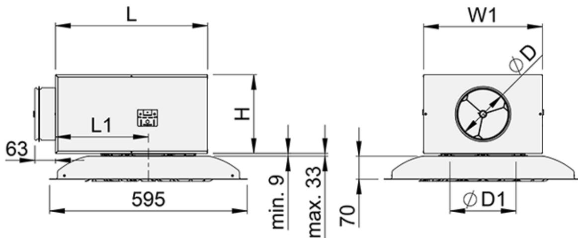
*Fig. 6. Dimensions du Halton Jaz JMC avec plénum Halton Pop PDI, manchette de raccordement placée à l'intérieur*
