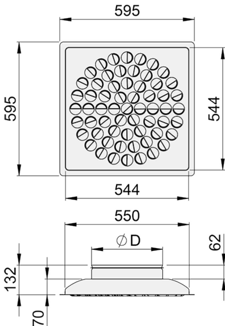
Fig.4. Dimensions du diffuseur Halton Jaz JMC
