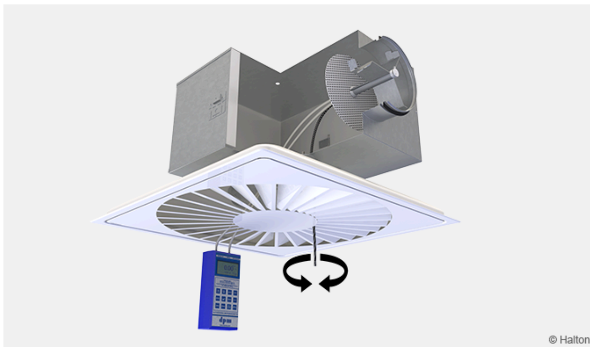
Fig. 5. Justering av luftflödet för spridaren och anslutningslådan.
