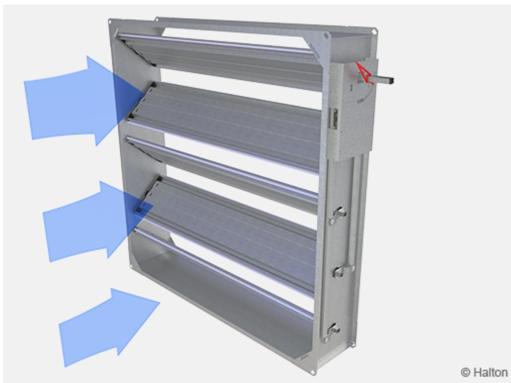
Les registres UTK sont utilisés pour la fermeture, le réglage ou l'équilibrage de débit dans les gaines de ventilation où l'on ne demande pas d'étanchéité particulière. L'étanchéité du registre UTK en position fermée sera conforme à la classe 1 selon la norme EN1751.
