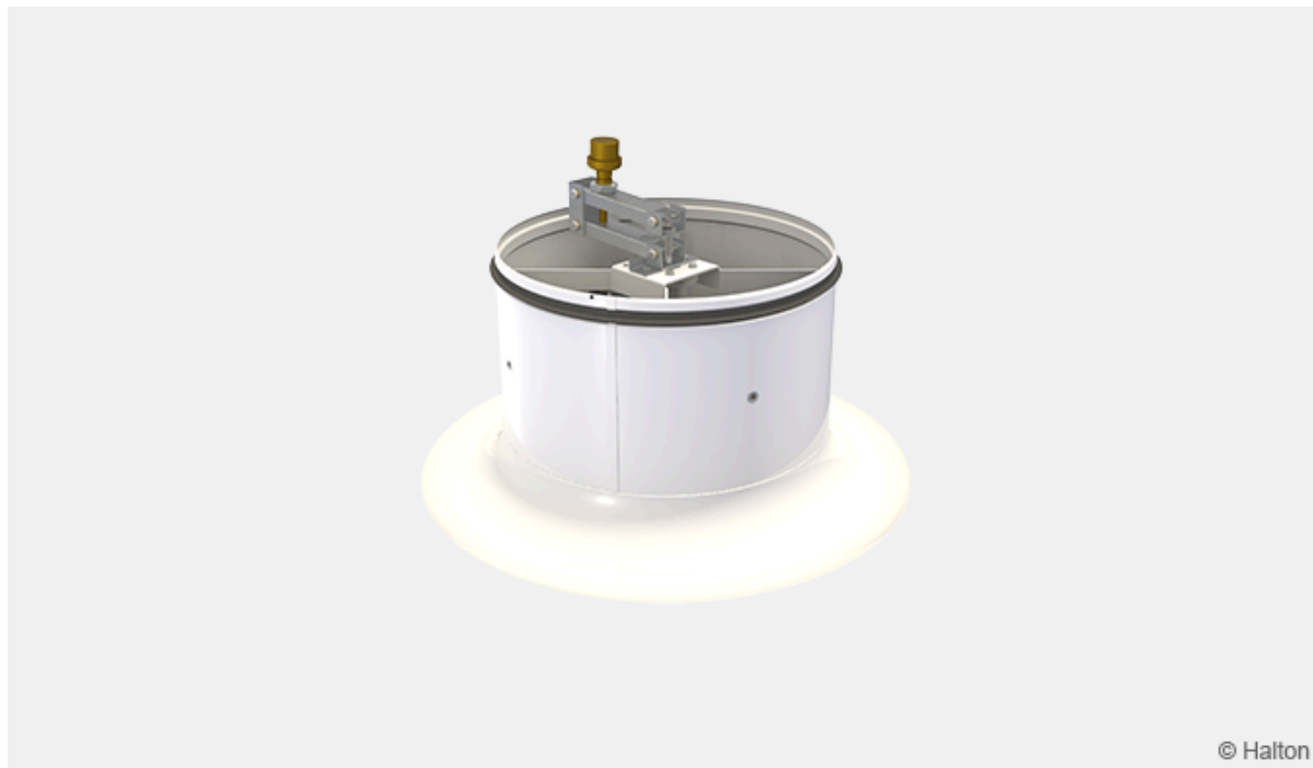
Kuva. 7. Halton TSA ja Siemens GDB161.2E/HA toimilaitte, käyttöjännite 24 VAC ja suhteellinen 0...10 VDC:n säätösignaali.
