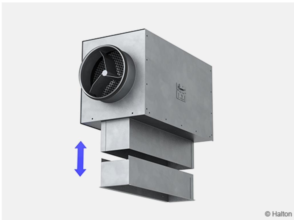
Le plénum Halton PRL se raccorde sur la gaine par un piquage équipé d'un joint. Le raccordement de la gaine peut se trouver sur le côté, le dessus, le dessous ou l'arrière du caisson. En raison de la construction symétrique du Halton PRL, il est possible d'effectuer le raccordement de différentes manières : il suffit de tourner le caisson vers la droite ou la gauche ou de le retourner (dessus/dessous).
