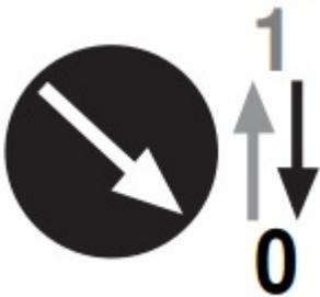
Le registre doit être complètement ouvert lorsque le signal de commande est de 0 V.
