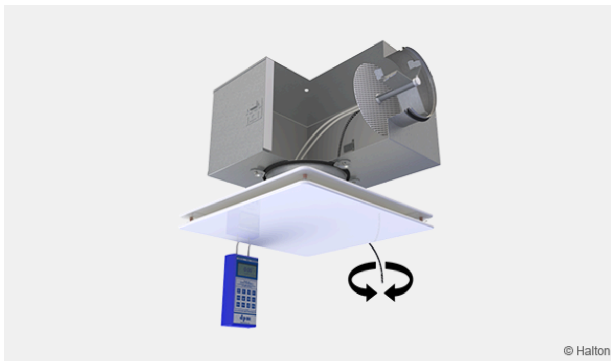
Fig. 6. Justering av luftflödet för spridaren och anslutningslådan.
