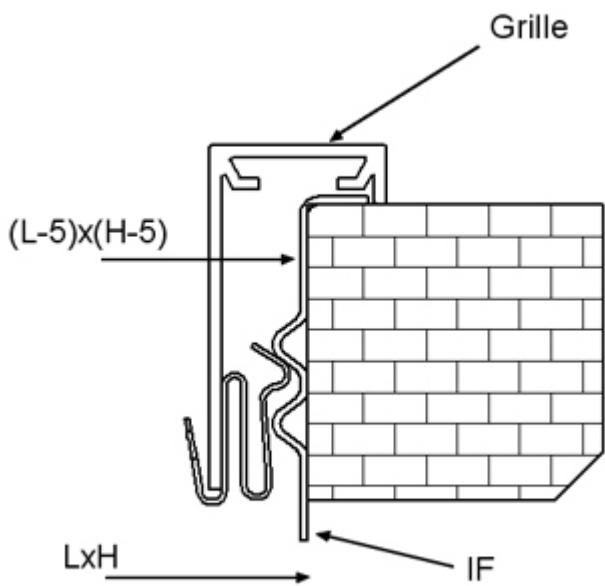
Die Gitter werden standardmäßig mit einer Klemmfederbefestigung für den Einbau mit IF Montagerahmen geliefert. Der Montagerahmen ist gesondert zu bestellen.
