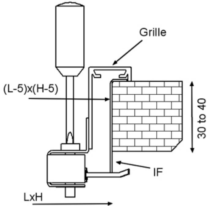
Eine verdeckte Schraubbefestigung ist möglich, wenn das Gitter mit einem IF Montagerahmen installiert wird.(IF). Der Montagerahmen ist gesondert zu bestellen.
