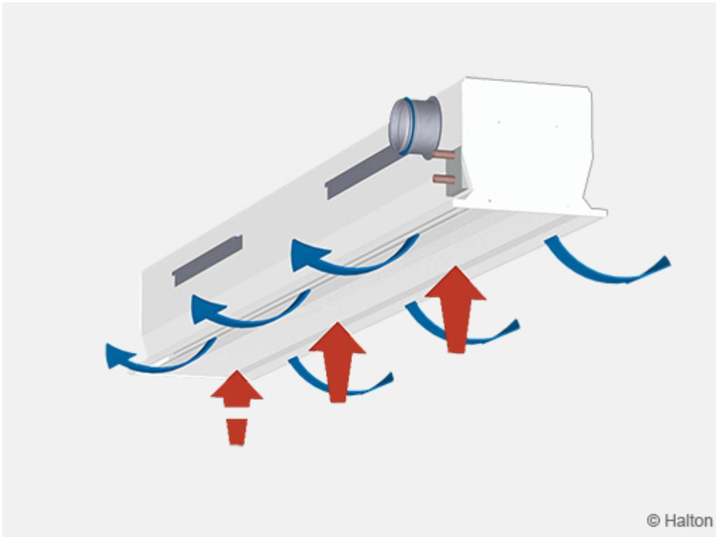
Die Primärluft (Frischluf) strömt in den Zuluftkanal des aktiven Kühlbalkens, von wo sie durch die Düsen und die Schlitze auf der Unterseite des Balkens im Raum verteilt wird.
