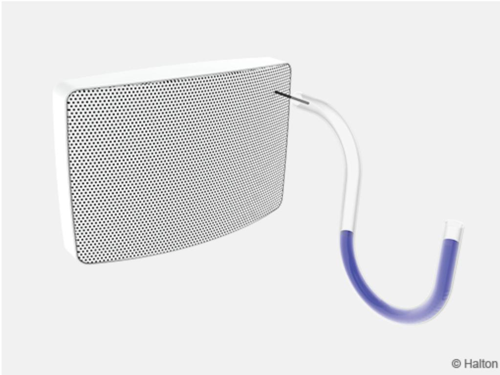
Placer le tube de mesure à l'intérieur de la bouche et mesurer la pression différentielle avec un manomètre.
