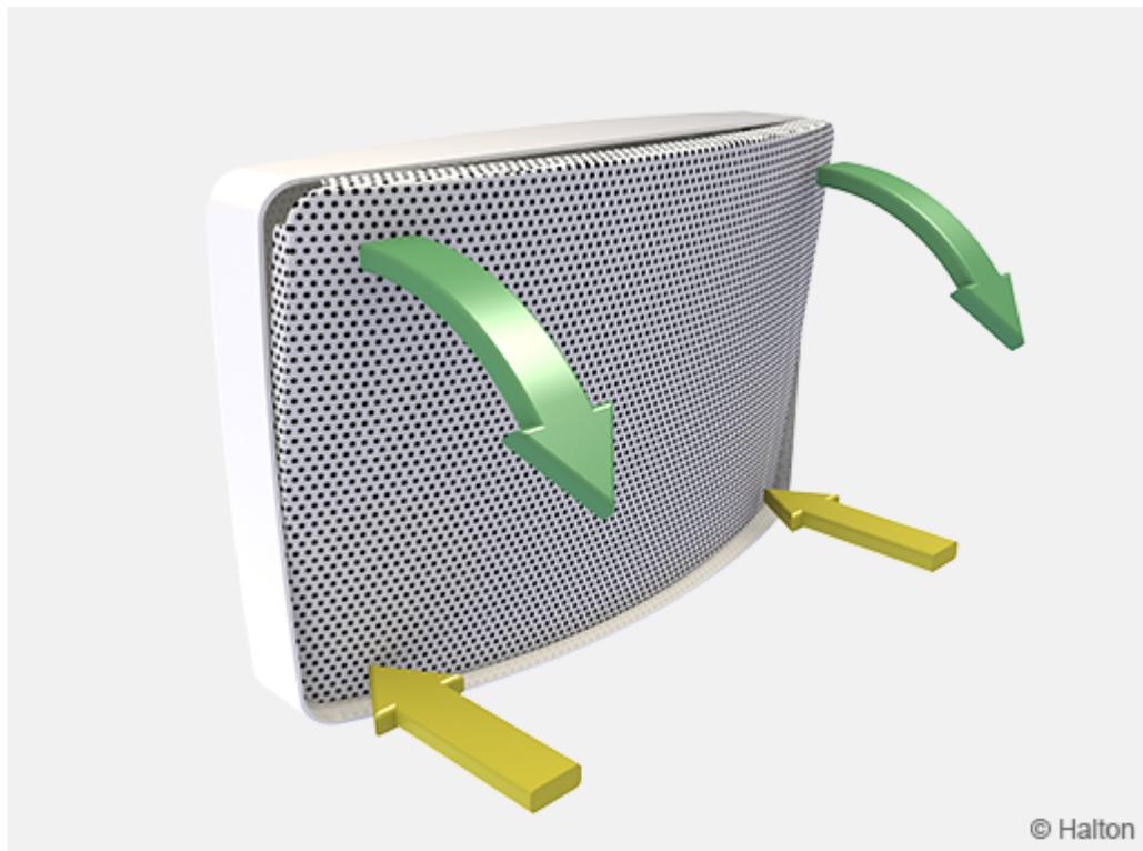
Appuyer simultanément sur les 2 côtés du panneau avant et déposer le panneau avant. Nettoyer les composants avec un tissu humidifié, ne pas les plonger dans l'eau.
