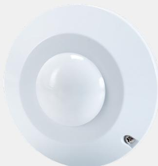
Le capteur Halton HOS-OE2 est un capteur de présence infrarouge passif destiné à être utilisé dans des installations de ventilation à la demande. Le capteur est prévu pour un montage plafonnier, offrant ainsi un schéma de détection en 360° avec une distance maximale de 10,5 m.
