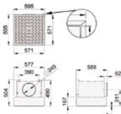
Raccordement circulaire sur le dessus Ø400
