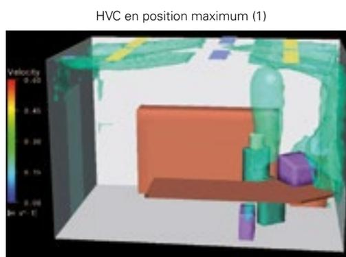
Simulation CFD d'un bureau équipé des poutres froides, utilisées en mode rafraîchissement, situation d'été. Les vitesses dans la zone d'occupation sont comprises entre 0,05 et 0,15 m/s.
