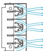
En montage mural, la veine d'air est projetée horizontalement ou diffusée avec effet de plafond le long de la paroi. Pour l'extraction, le diffuseur est fourni sans déflecteurs internes.
