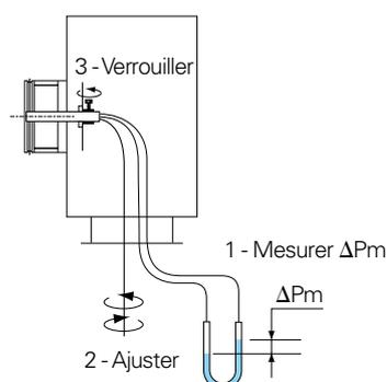
Après lecture du différentiel  $\Delta P_m$  [Pa], le débit d'air soufflé se calcule facilement grâce à la relation suivante :
