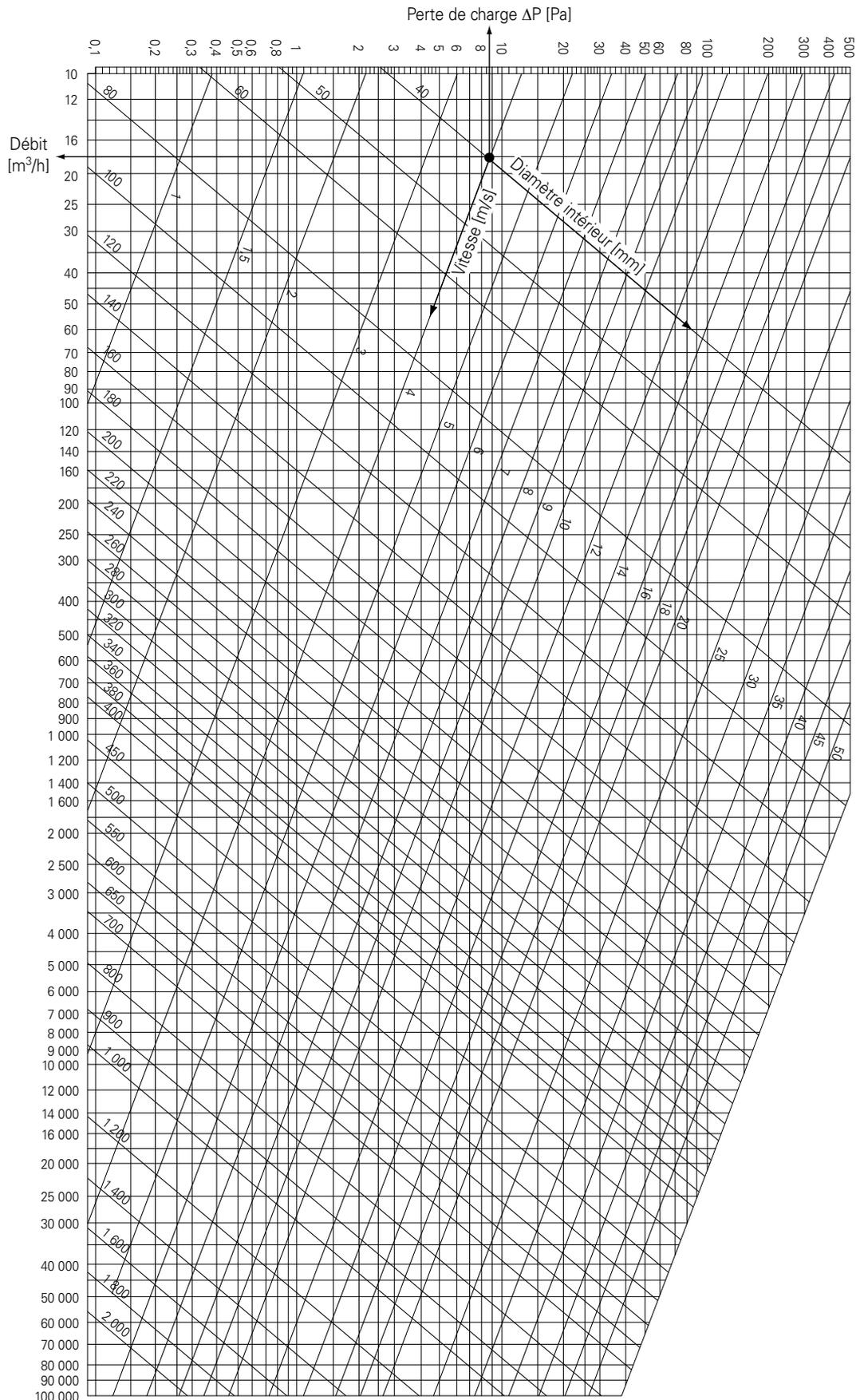
Les pertes de charge sont calculées sur la base d'un poids spécifique de l'air de 1,2 kg/m<sup>3</sup> pour des gaines circulaires droites en tôle d'acier galvanisé avec un joint par mètre.
