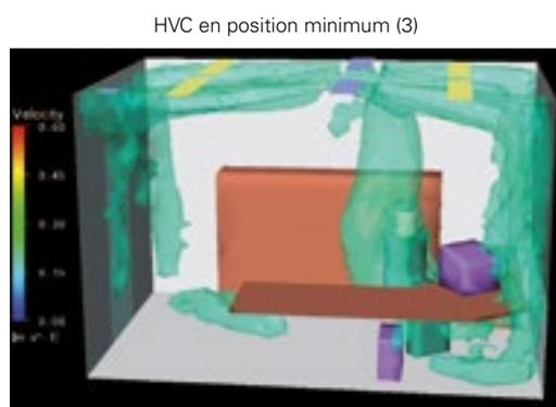
Simulation CFD d'un bureau équipé de poutres froides, utilisées en mode rafraîchissement, situation d'été. Les vitesses dans la zone d'occupation sont comprises entre 0,10 et 0,25 m/s.
