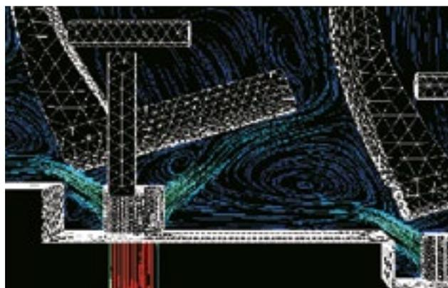
Simulation numérique d'un diffuseur de sol de type BCF
