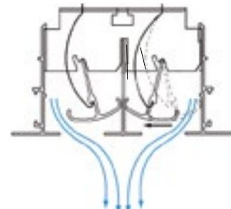
En mode chauffage, la température de soufflage devra être supérieure à 25 °C. Quand la température de l'air soufflé est supérieure à 25 °C, la cire se dilate et permet le changement de position des ailettes. Le SLN passe automatiquement en mode projection.
