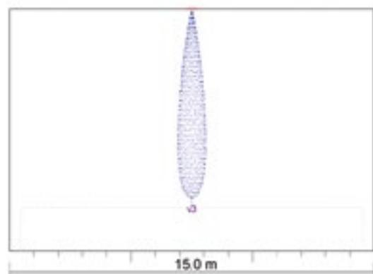
Note : le logiciel Halton HIT Design permet d'effectuer des simulations de veine d'air particulièrement utiles dans le cas des locaux de grandes hauteurs. Les dimensions du local, le différentiel de température (soufflage - ambiance), l'angle de soufflage, le débit font partie des variables paramétrables. Disponible gratuitement sur demande.
