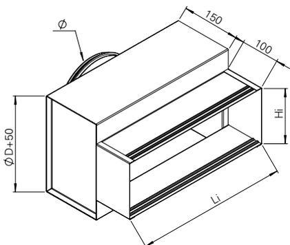
👍 Pour les BDR/S-B, BDR/L-B et BDR/T-B au soufflage, nous vous conseillons d'ajouter une tôle perforée à l'intérieur de la boîte de raccordement.
