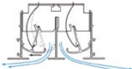
En mode rafraîchissement, la température de soufflage devra être inférieure à 21 °C. Quand la température de l'air soufflé est inférieure à 21 °C, la cire se contracte et permet le changement de position des ailettes. Chaque ailette se met automatiquement en position de diffusion.
