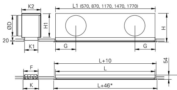
Les dimensions standard de l'ensemble plénum + diffuseur sont données dans le tableau Dimensions (dimensions H).
