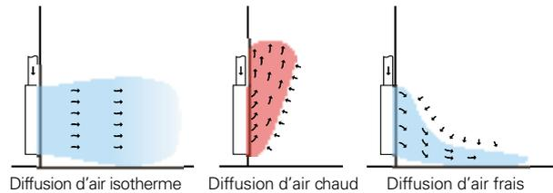
Modèles de diffusion de flux d'air à différentes températures
