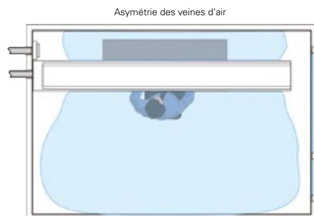
Lorsque la cloison est située près de la poutre climatique Halton, le système HVC est réglé sur la position 1 d'un côté et sur la position 3 de l'autre de manière à obtenir une diffusion d'air asymétrique.
