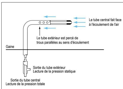
Principe de mesure des pressions sur tube de Pitot
