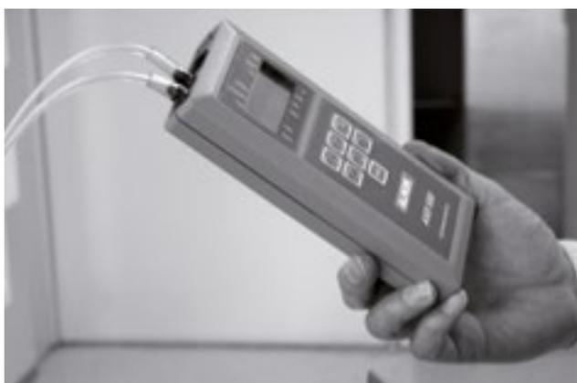
9. Mesurer la différence de pression avec un manomètre différentiel.
