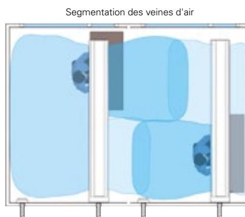
L'ajustement des conditions de vitesses locales est possible également dans un bureau décloisonné avec un système de contrôle de vitesses HVC.
