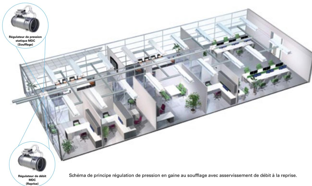
Schéma de principe régulation de pression en gaine au soufflage avec asservissement de débit à la reprise.
