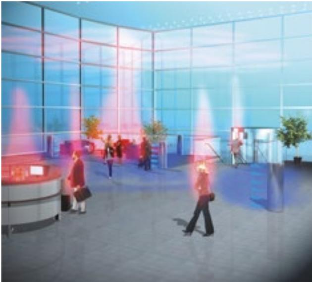
Application type d'un système de diffusion par déplacement
