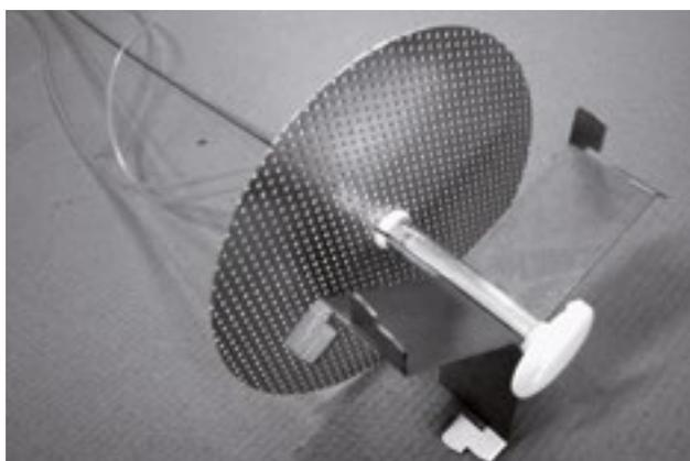
8. Appareil de mesure et de réglage MSM (en option). La différence de pression est mesurée à l'intérieur du plénum, ce qui permet de régler le débit soufflé.
