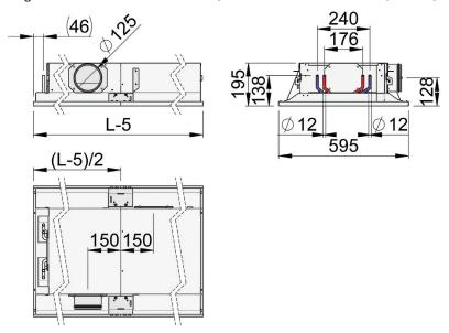
Longueur totale 1200 à 2400 mm; batterie haute efficacité, double circuit (CE=H2)
