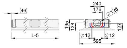
Longueur totale 1200 à 2400 mm; batterie haute efficacité, double circuit (CE=H2)
