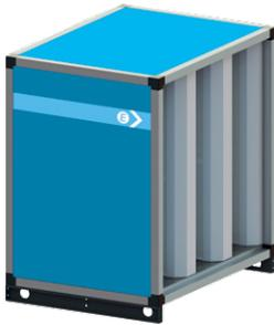
옵션으로 멜릭스 내부 코팅을 갖춘 내장형 소음 감소 장치는 폴루스탑, 에어로리즈 및 익스텐소 장치에 사용 가능하며, 이는 덕트 내부의 소음 전달을 축소시킵니다. 기본 구조는 100 mm 공기 통로와 200 mm의 분리 장치로 되어 있고, 900 mm, 1200 mm 및 1500 mm의 길이 옵션이 있습니다. 특정한 소음 기준의 경우에는 반드시 전문적인 음향학적 조언을 구해야 합니다.
