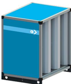
옵션으로 멜릭스 내부 코팅을 갖춘 내장형 소음 감소 장치는 폴루스탑, 에어로리즈 및 익스텐소 장치에 사용 가능하며, 이는 덕트 내부의 소음 전달을 줄이기 위하여 제작되었습니다. 기본 구조는 100 mm 공기 통로와 200 mm의 분리 장치로 되어 있고, 900 mm, 1200 mm 및 1500 mm의 길이 옵션이 있습니다. 특정한 소음 기준의 경우에는 반드시 전문적인 음향학적 조연을 구해야 합니다.
